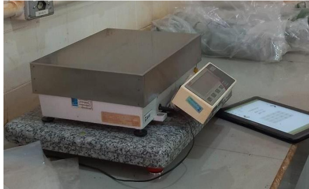
Figura 4: Balança convencional utilizada para pesagem de material verde.
