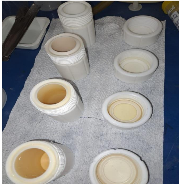
Figura 9: Reatores em teflon utilizados na síntese da zeólita
