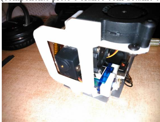
Figura 21 – Servomotor (componente azul) com chave para compensação de nivelamento automática (componente preto e branco com detalhe em vermelho)
