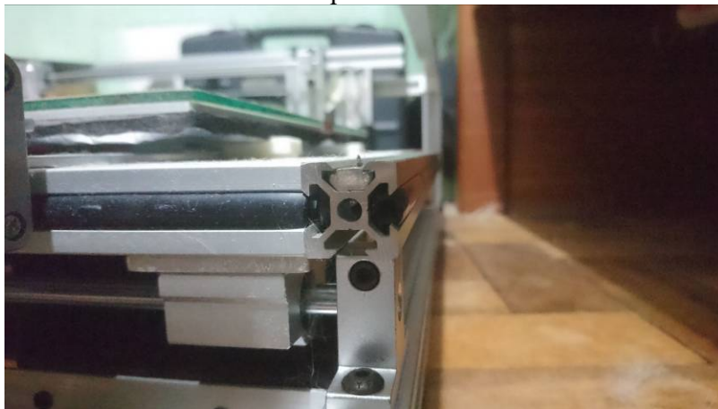
Figura 15 - Montagem V-Slot com parafuso interno e porcas específicas para o perfil em questão
