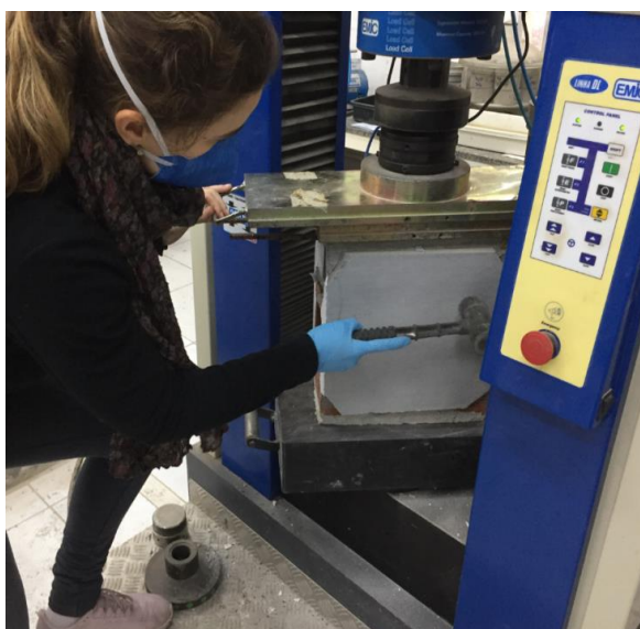
Figura 14 – Exemplo de execução do ensaio de percussão
