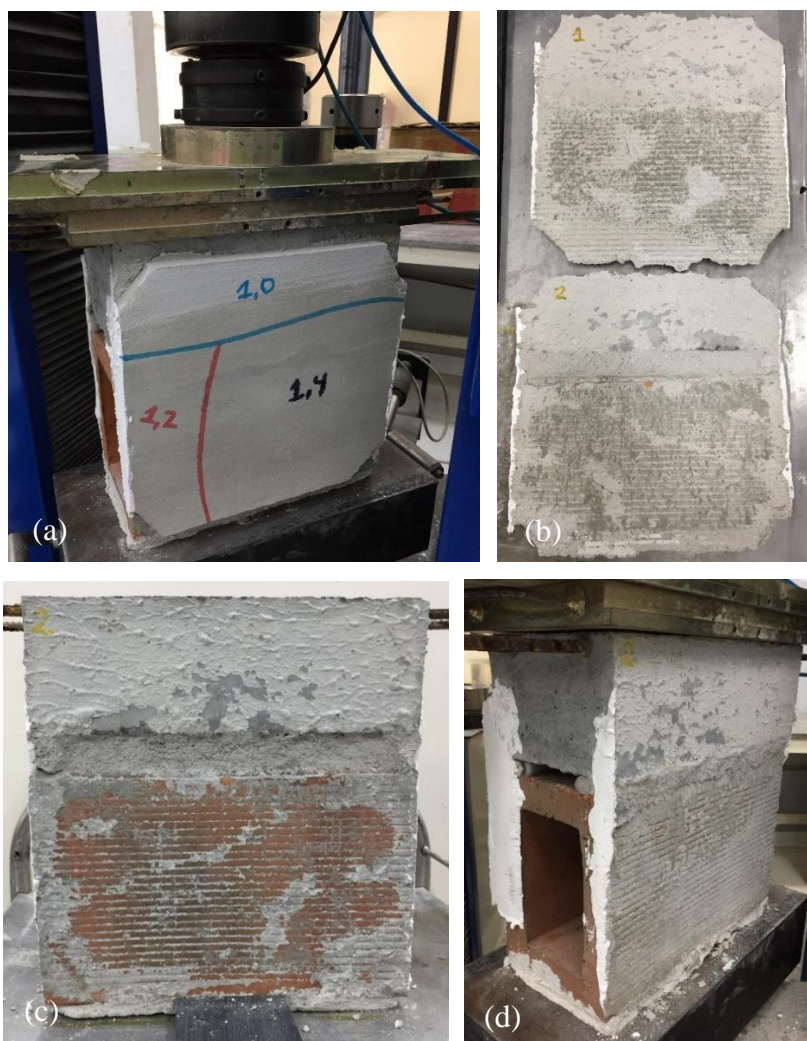
Figura 59 – Principais danos ao longo do ensaio para as configurações Fix. 1 e 2 cm FB-RI: (a) descolamento total do revestimento, (b) faces deslocadas, (c) e (d) deslocamento do revestimento, (e) e (f) descolamento do revestimento
