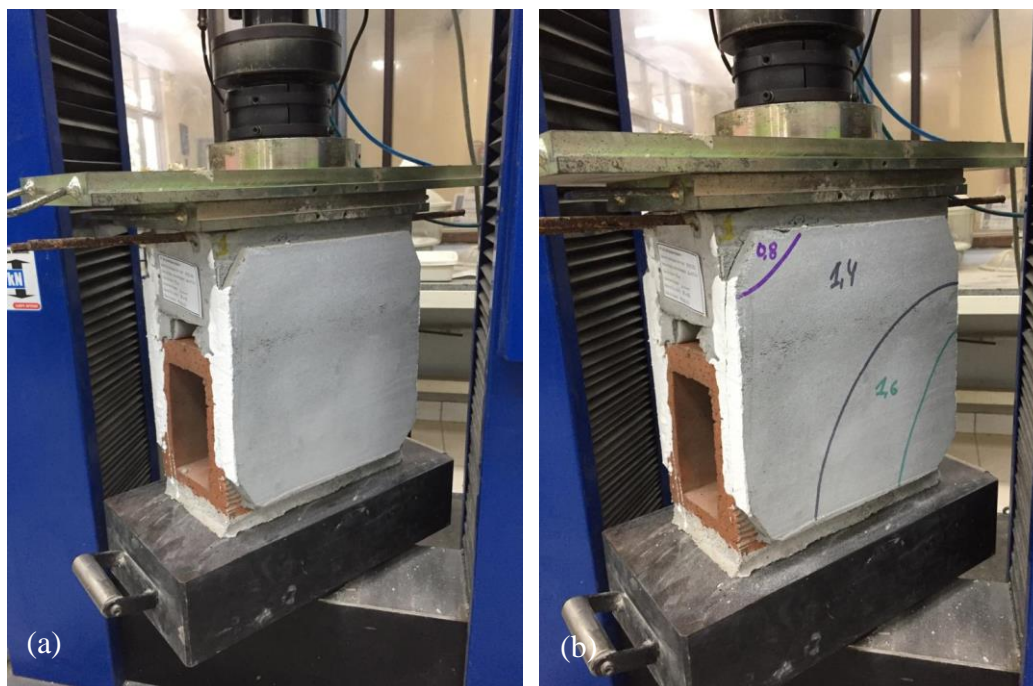
Figura 15 - Exemplo de marcação de danos no prisma durante ensaio de deformações verticais: (a) antes do ensaio e (b) depois do ensaio
