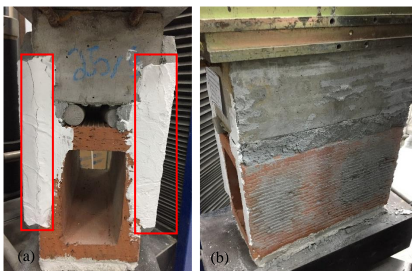
Figura 54 – Principais danos observados ao longo do ensaio de deformações verticais para as configurações Fix. 1 e 2 cm FI-RB: (a) descolamento do revestimento, (b) deslocamento do revestimento, (c) esmagamento da fixação superior e (d) descolamento total do revestimento
