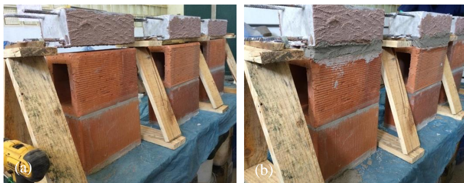
Figura 32 – Primeira proposta de adaptações aos modelos de prisma: (a) montagem com cavaletes, (b) fixação superior, (c) revestimento com moldura e (d) ensaio na prensa com algoritmo
