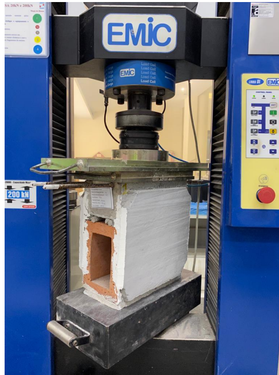
Figura 11 - Exemplo do prisma proposto em ensaio de deformações verticais na prensa hidráulica
