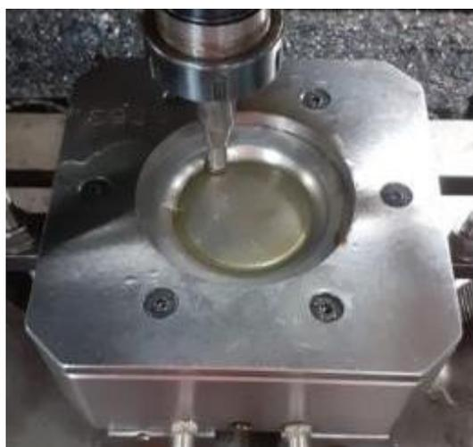
Figura 35: Estampagem Incremental das amostras de alumínio AA1200-H14 no centro de usinagem CNC
