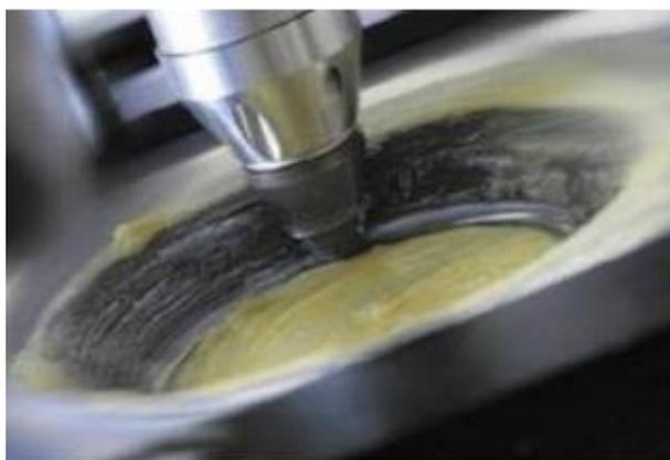
Figura 21: Estampagem incremental utilizando como lubrificante graxa convencional.
