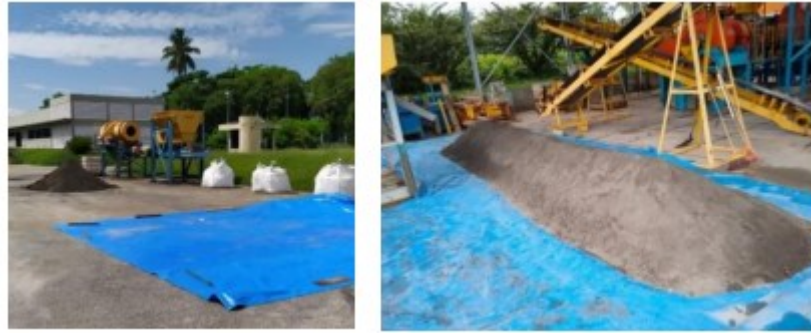
Figura 32 - Etapas de homogeneização: pilha cônica e alongada para caracterização
