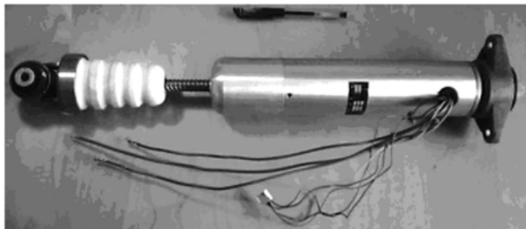
Figura 8 – Protótipo de atuador eletromagnético com motor CC rotativo e fuso.
