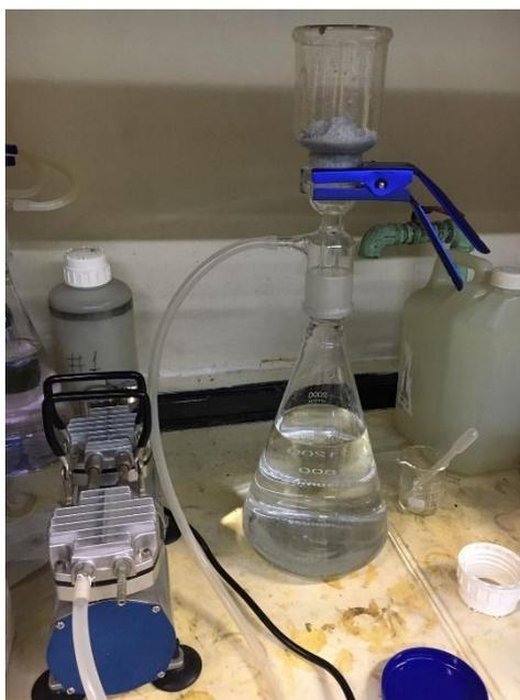
**Figura 33.** Sistema de filtração com bomba a vácuo. Fonte: próprio autor.
