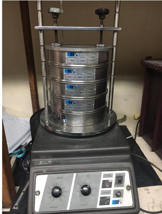
**Figura 34.** Separação granulométrica. Fonte: próprio autor.
