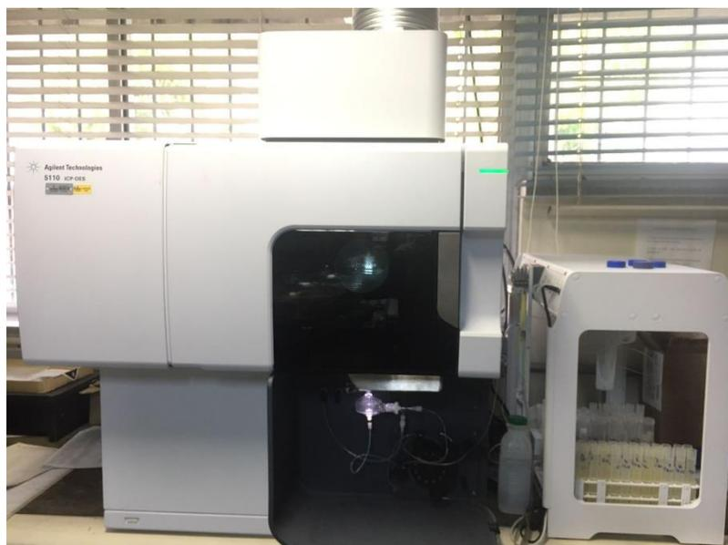
**Figura 30.** Equipamento ICP-OES da marca Agilent Technologies, modelo 5110.
