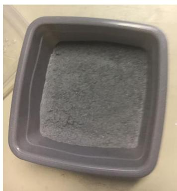
**Figura 25.** Amostra de painel solar com granulometria inferior a 1mm. Fonte: próprio autor.
