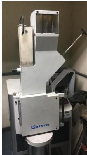
**Figura 24.** Moinho de facas da marca Retsch, modelo SM300 utilizado na cominuição. Fonte: próprio autor.
