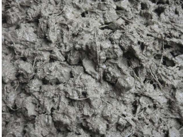
Figura 2 – Fibras dispersas aleatoriamente na matriz de concreto
