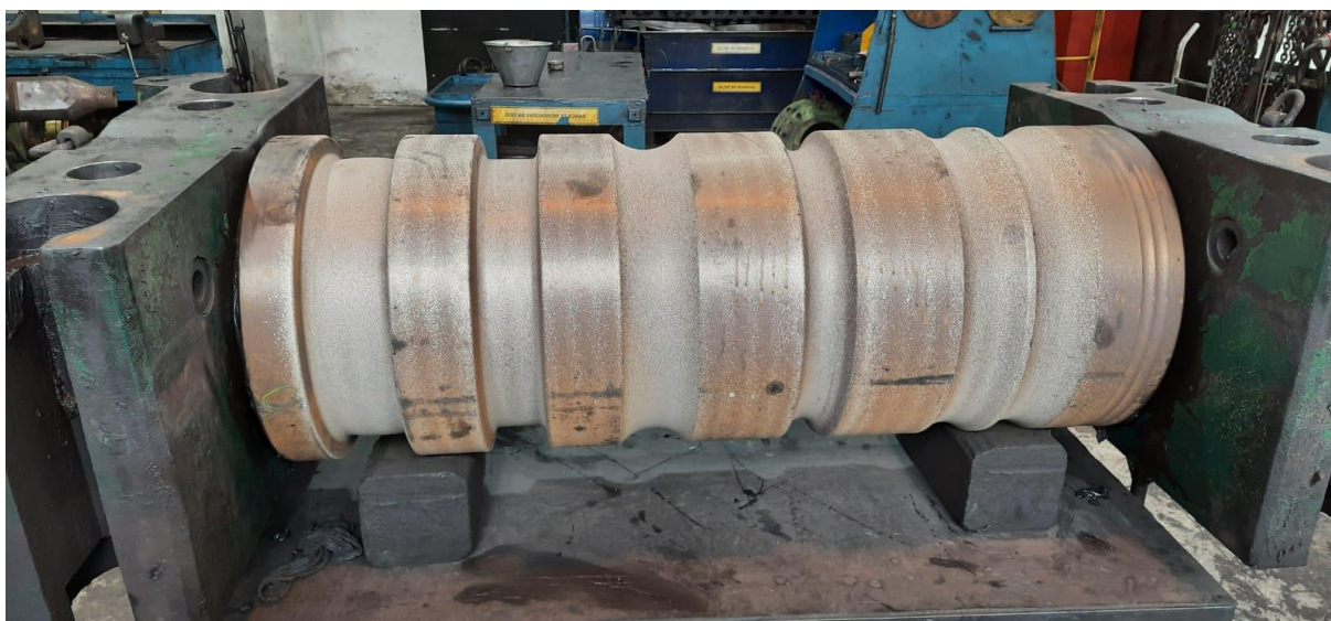
Figura 6. Cilindro de laminação do laminador trio da L1.
