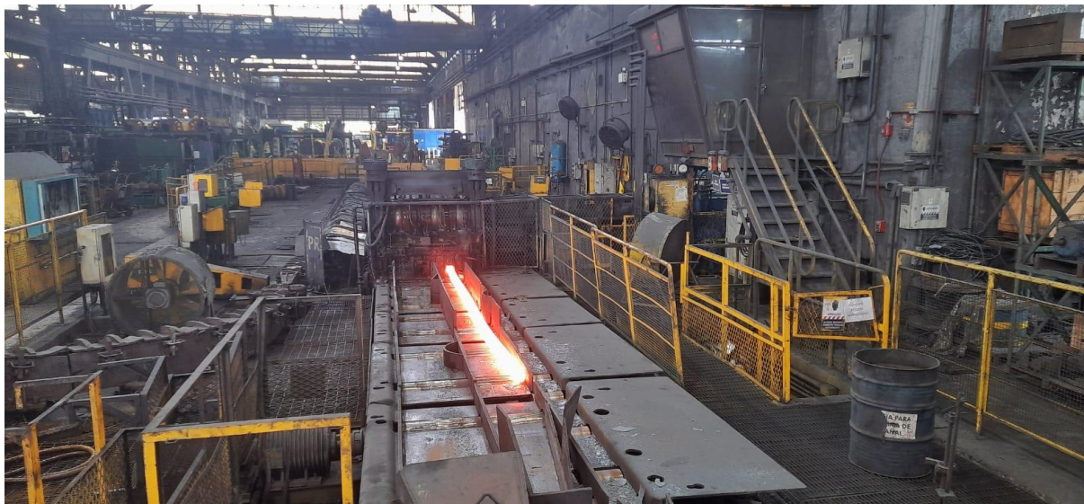
Figura 7. Gaiola trio operando na saída do segundo passe.
