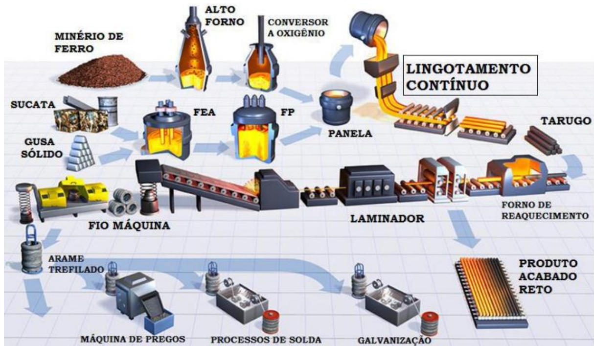
Figura 1. Fluxo simplificado do processo siderúrgico.
