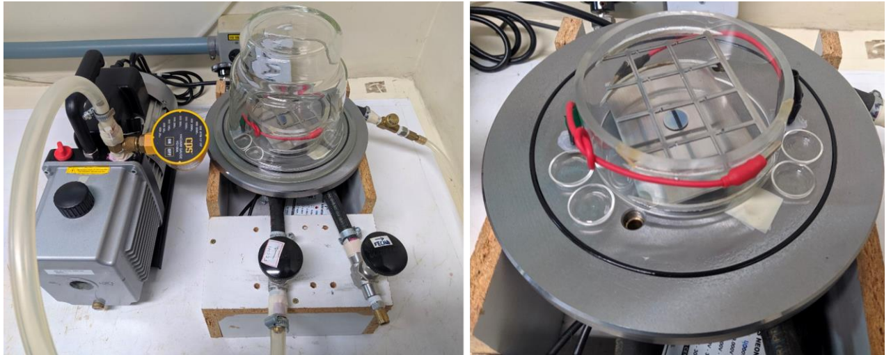
Figura 12: Reator utilizado na Polimerização por Plasma Frio do óleo essencial de Eucalyptus globulus .
