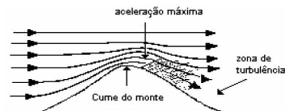
Figura 2 - Representação da influência da topografia no vento (CALDAS, 2010)
