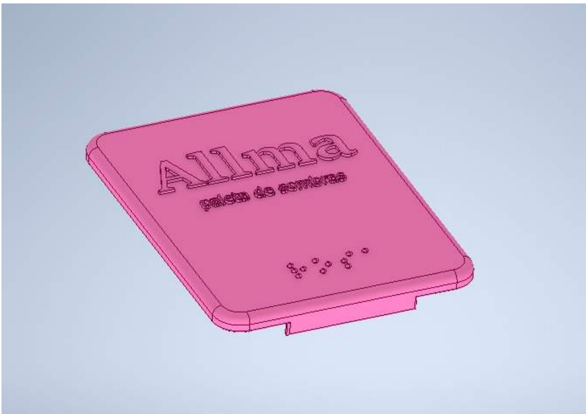
Figura 35 - Desenho do componente externo superior externo no Autodesk Inventor® com o relevo do nome da marca e Braille
