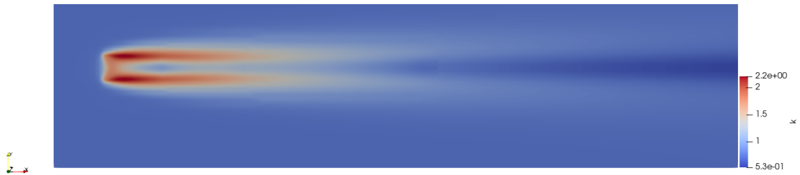
Figura 8 - Campo de energia cinética turbulenta para o modelo k-\epsilon , vista do plano na altura média do disco atuador
