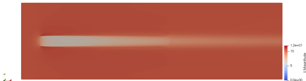
Figura 6 - Campo de velocidades na região da esteira aerodinâmica para o caso RSM, vista do plano na altura média do disco atuador
