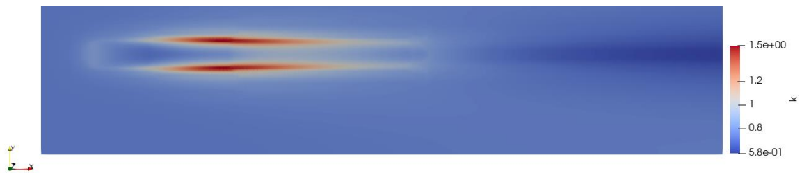
Figura 9 - Campo de energia cinética turbulenta para o modelo RSM, vista do plano na altura média do disco atuador
