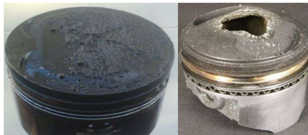
Figura 4: Exemplo de pistões danificados por detonação severa. Fonte: Adamo, 2015.
