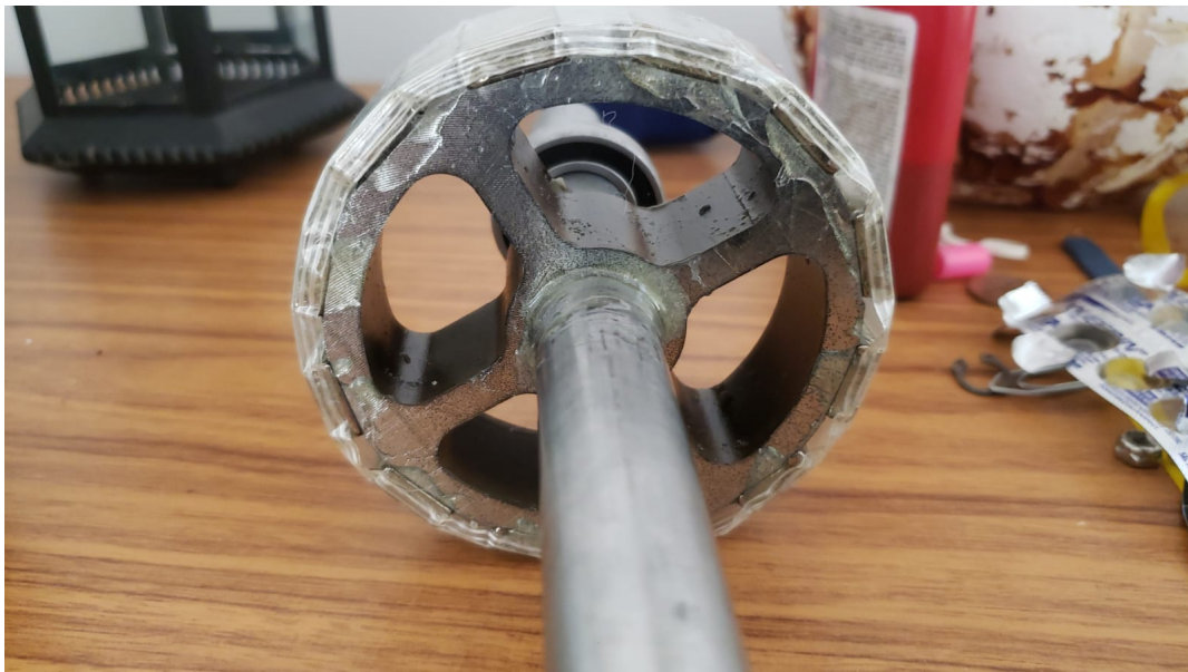
Figura 30 – Rotor com ímãs e aplicação de fita com filamento de fibra de vidro.
