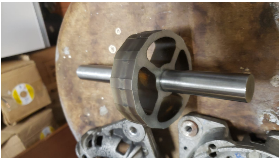
Figura 28 – Peça usinada do rotor com eixo inserido.
