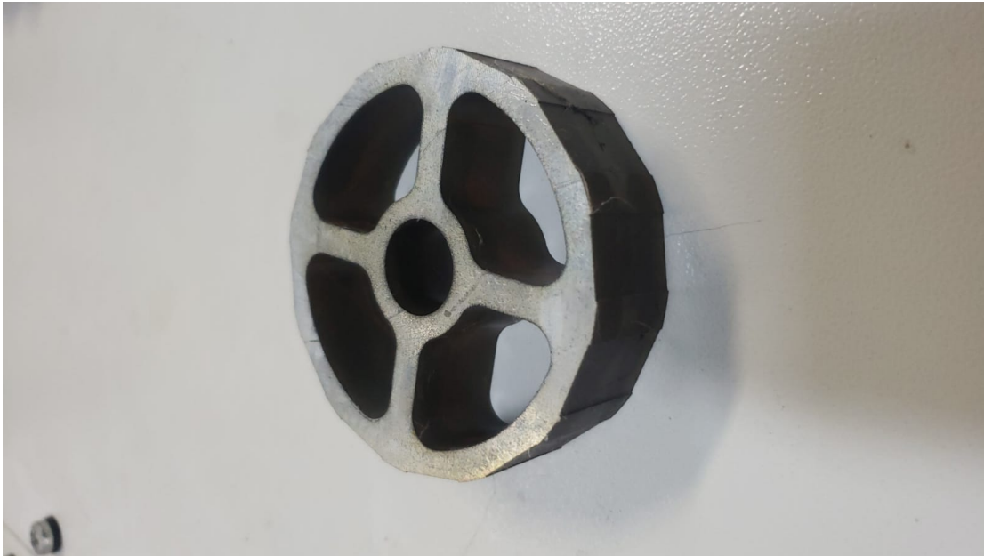
Figura 26 – Peça do rotor usinado.
