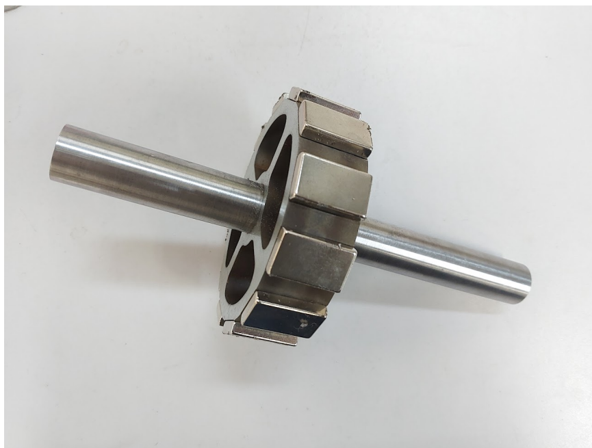
Figura 29 – Rotor após a montagem dos ímãs.
