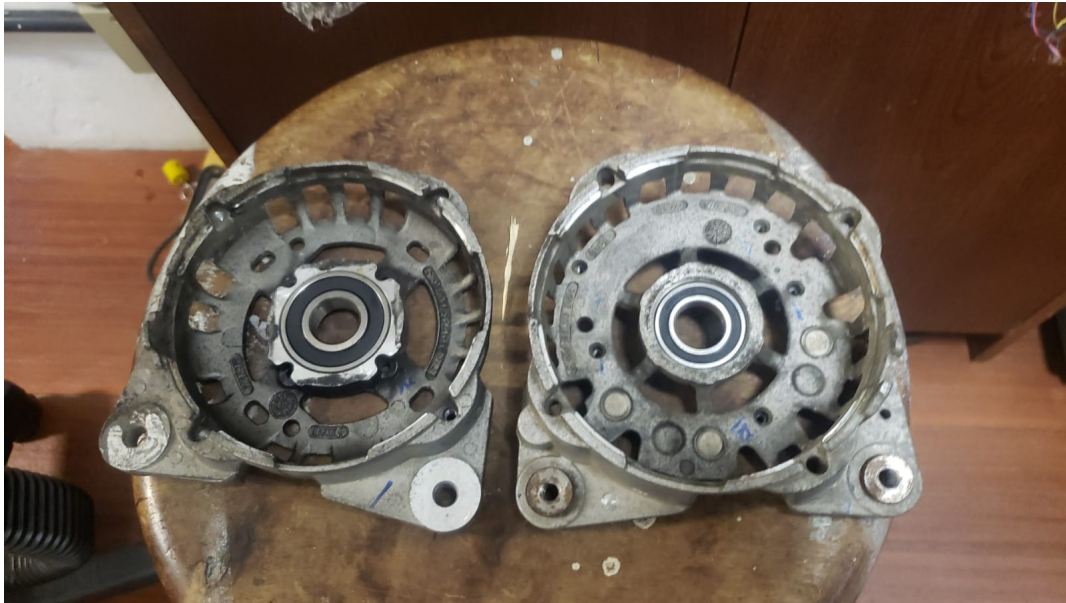
Figura 27 – Carcaça do alternador com rolamentos inseridos.
