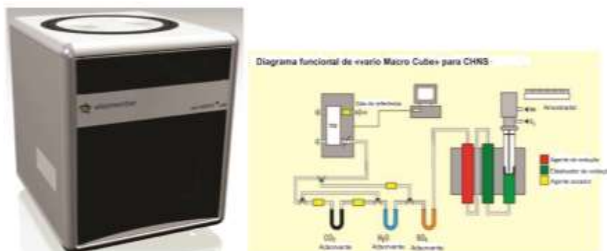
Figura 12: Equipamento e o diagrama de funcionamento de Elementar”, modelo “Vario macro Cube para CHNS, disponível nos laboratórios de Núcleo de Estudos de Carvão e Rochas Geradoras de Petróleo, IGEO, UFRGS.
