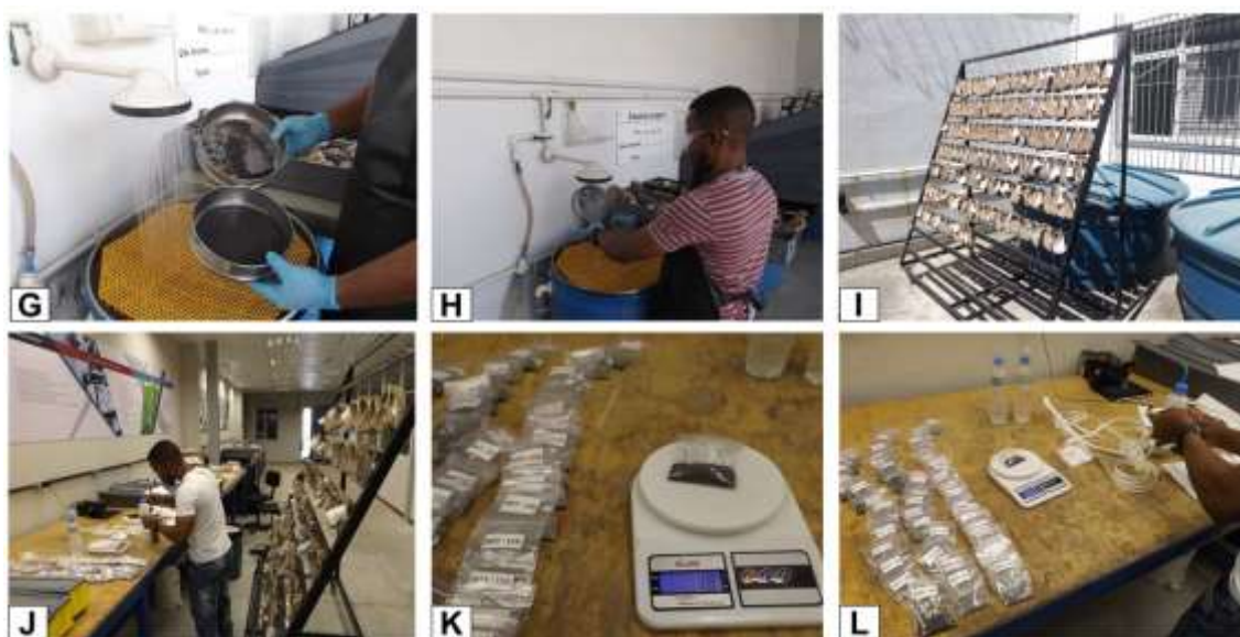
Figura 10: Lavagem e pulverização das amostras: G- amostra em peneiras de 16 mesh e 250 mesh previamente lavadas; H- recolocação da amostra lavada em saco previamente lavado; I- amostras no varal em processo de secagem; J- pulverização das amostras após a secagem; K, L- pesagem de amostra na balança de precisão e etiquetagem.
