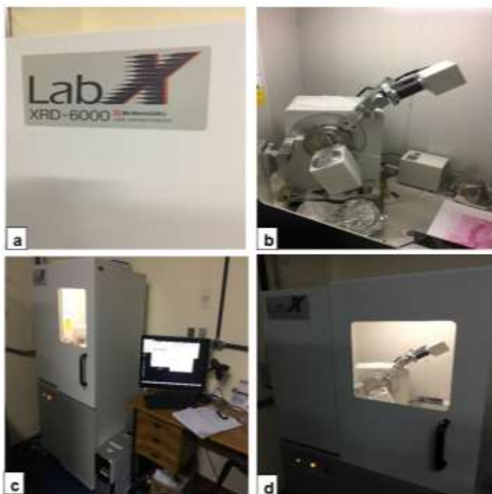
Figura 11: Processo de análise de amostras por difração de raios X (DRX); a) difratômetro de raios X XRD 6000 da marca Shimadzu; b) imagem interna do difratômetro de raios X com amostra acoplada numa placa metálica; c) Equipamento e software Xpert Highscore em funcionamento; d) momento de início da análise de difração de raios X.
