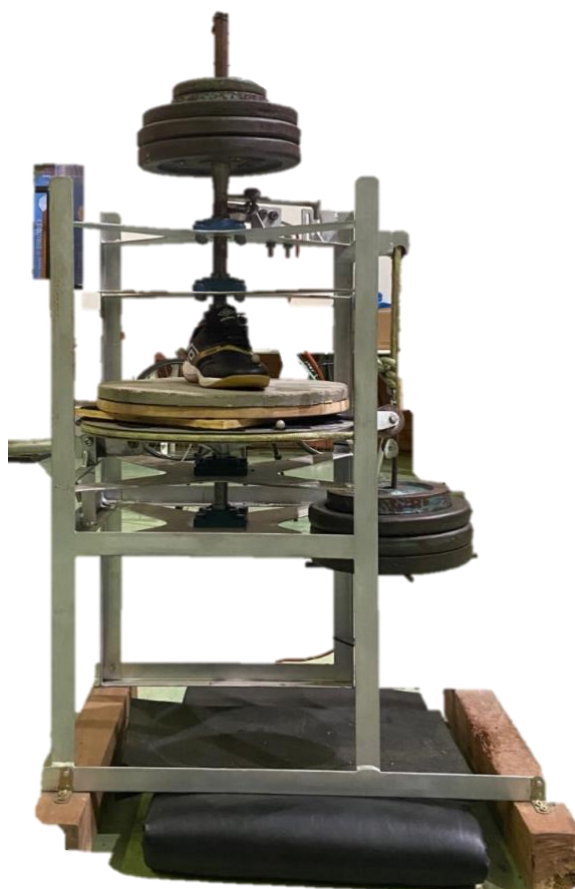
Figura 2: Aparato mecânico ilustrando a chuteira avaliada contra um piso de cimento. As anilhas no topo simulam a carga compressiva, enquanto as anilhas na lateral definem a velocidade de rotação do disco-base Fonte: Acervo particular do autor.
