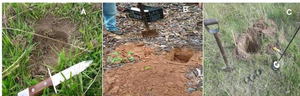
Figura 3. Detalhes da amostragem: a) remoção da amostra indeformada no campo; b) minitrincheira em solos sob eucaliptos; c) minitrincheira em campo nativo;
