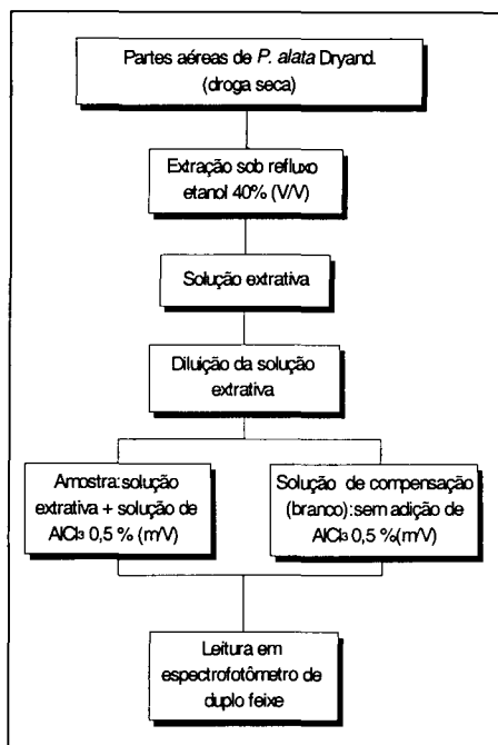
Figura 1 – Metodologia geral de extração e comparação de amostras e leitura.
