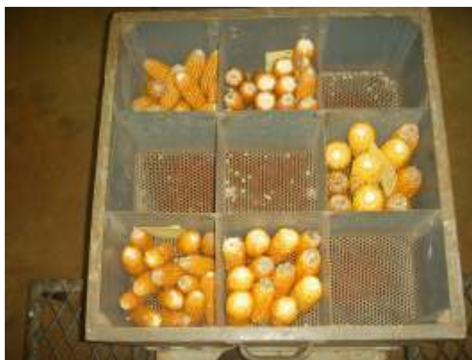
FIGURA 2. Compartimento do secador artificial de pequena escala, subdivididas em nove células. Departamento de Pesquisa de Produção/Unidade de Beneficiamento Pioneer Sementes, Itumbiara, GO, 2009. Itumbiara, 2009.
