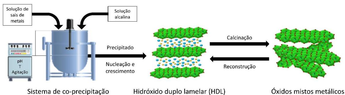
**Figura 3.7.** Sistema de co-precipitação para preparo de hidróxidos duplos lamelares (HDL) e óxidos mistos metálicos. Fonte: adaptado de (MISHRA; DASH; PANDEY, 2018).
