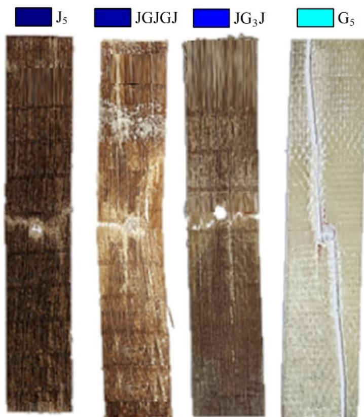
Figura 31: Fotografias dos principais modos de falha encontrados após os testes de tração.
