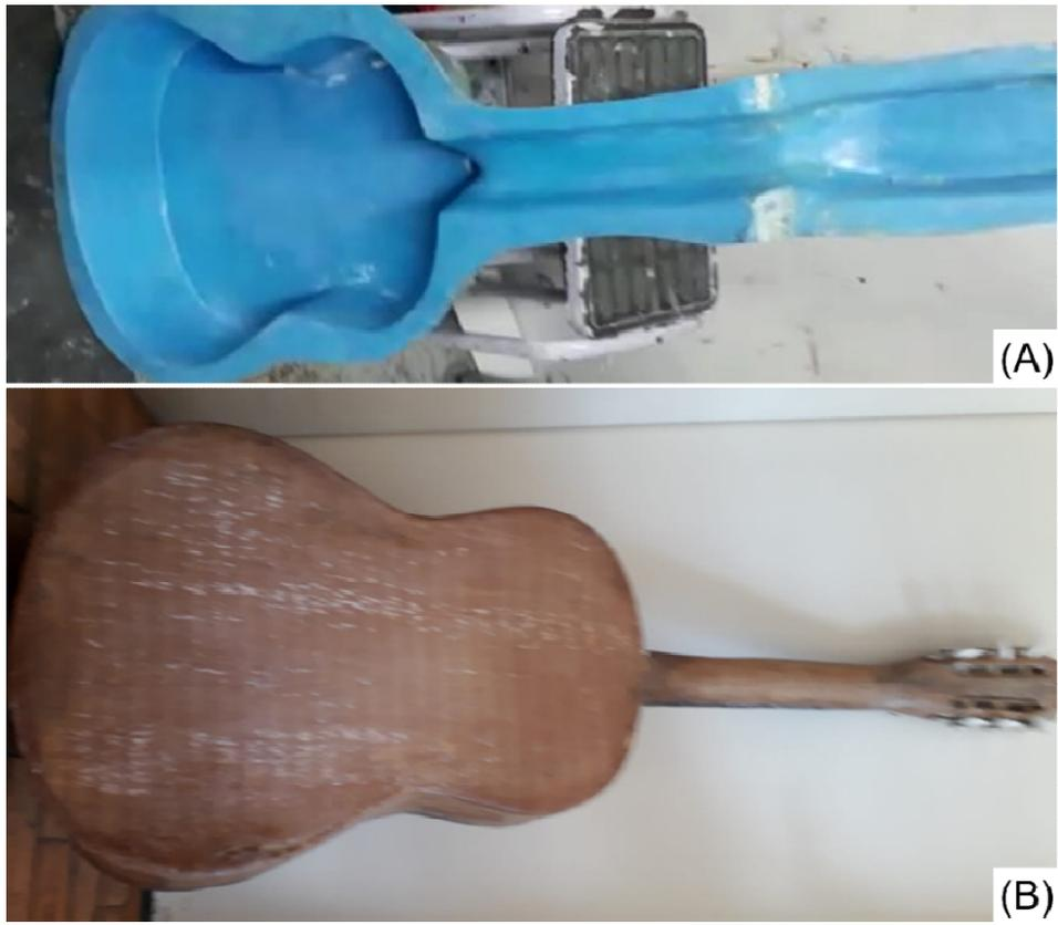
Figura 9: Fotografias da fabricação dos violões compósitos.
