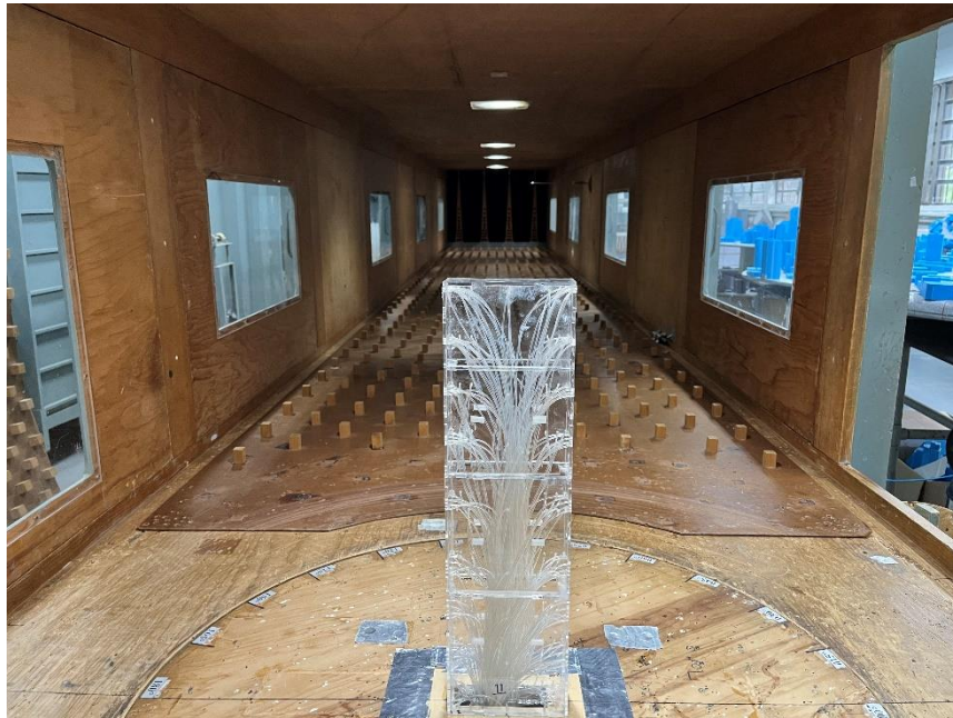
Figura 4.37: Modelo 9 do Grupo 3 na Mesa M-II do túnel de vento Prof. Joaquim Blessmann (fonte: autor).
