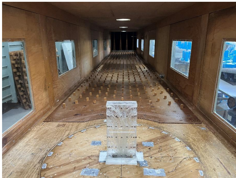
Figura 4.1: Modelo 1 do Grupo 1 na Mesa M-II do túnel de vento Prof. Joaquim Blessmann (fonte: autor).
