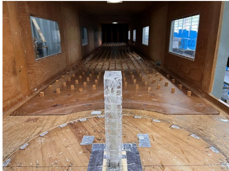
Figura 4.16: Modelo 4 do Grupo 2 na Mesa M-II do túnel de vento Prof. Joaquim Blessmann (fonte: autor).
