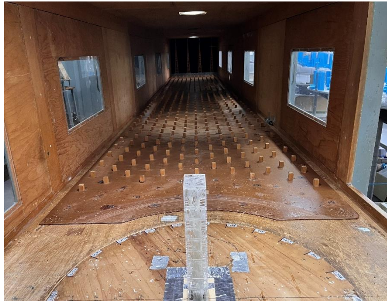
Figura 4.20: Modelo 5 do Grupo 2 na Mesa M-II do túnel de vento Prof. Joaquim Blessmann (fonte: autor).
