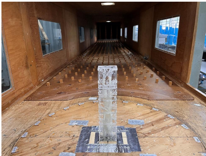
Figura 4.11: Modelo 3 do Grupo 2 na Mesa M-II do túnel de vento Prof. Joaquim Blessmann (fonte: autor).
