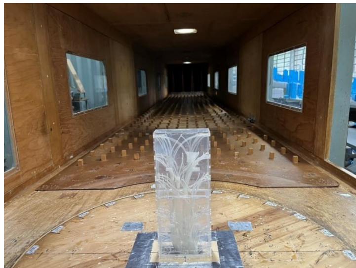
Figura 4.33: Modelo 8 do Grupo 3 na Mesa M-II do túnel de vento Prof. Joaquim Blessmann (fonte: autor).
