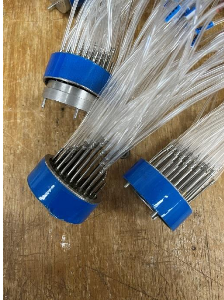
Figura 3.11: Transdutores de pressão e tubos pneumáticos conectados (fonte: autor).
