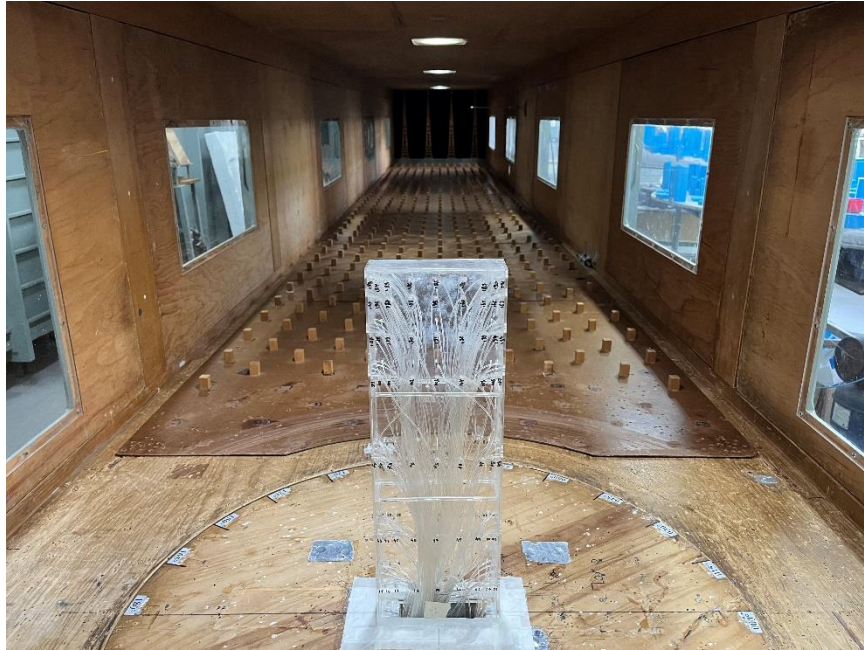
Figura 4.2: Modelo 2 do Grupo 1 na Mesa M-II do túnel de vento Prof. Joaquim Blessmann (fonte: autor).
