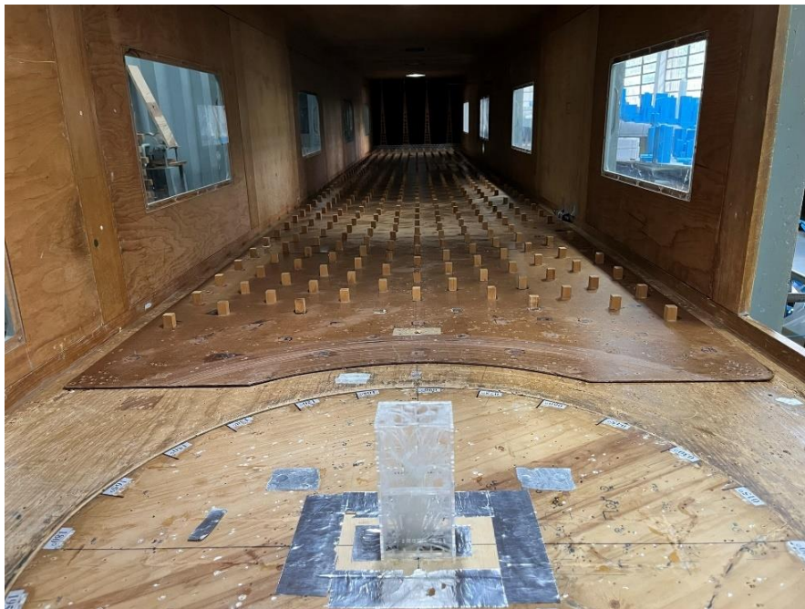
Figura 4.28: Modelo 7 do Grupo 3 na Mesa M-II do túnel de vento Prof. Joaquim Blessmann (fonte: autor).
