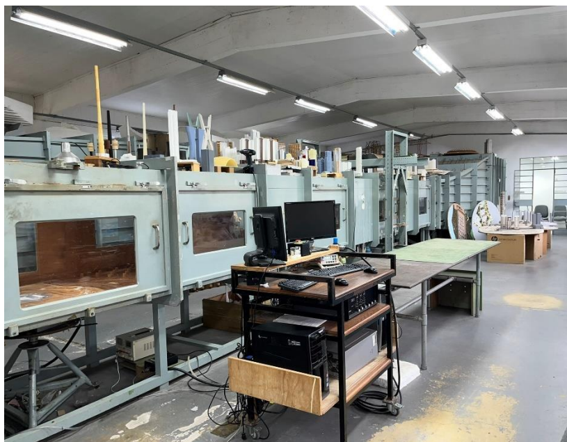
Figura 3.1: Túnel de vento Professor Joaquim Blessmann (fonte: autor).
