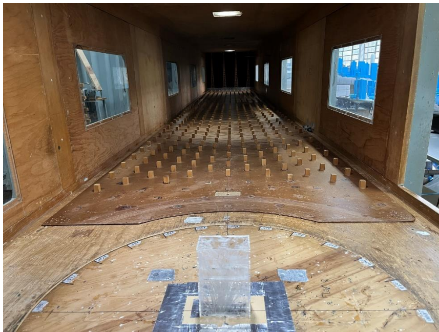
Figura 4.24: Modelo 6 do Grupo 3 na Mesa M-II do túnel de vento Prof. Joaquim Blessmann (fonte: autor).
