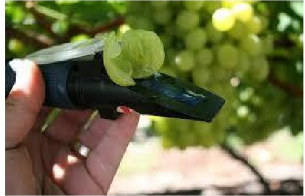
Figura 2 – Refratômetro para medir o teor de açúcar da uva.
