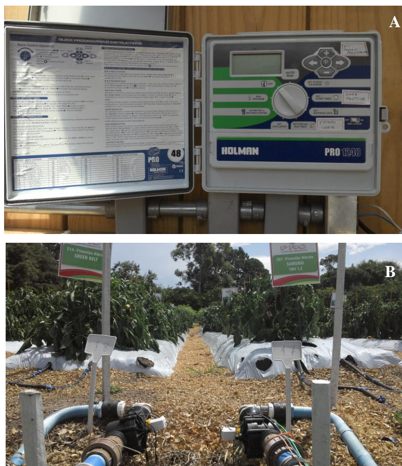
Figura 3. Irrigação automatizada. A: Controlador de irrigação Holman-Pro1248, B: estações 17 e 18, com suas respectivas válvulas eletrônicas, área de pimenteiros a campo. Foto do autor.
