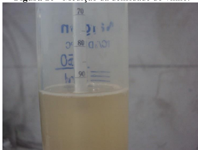
Figura 10 - Medição da densidade do vinho.
