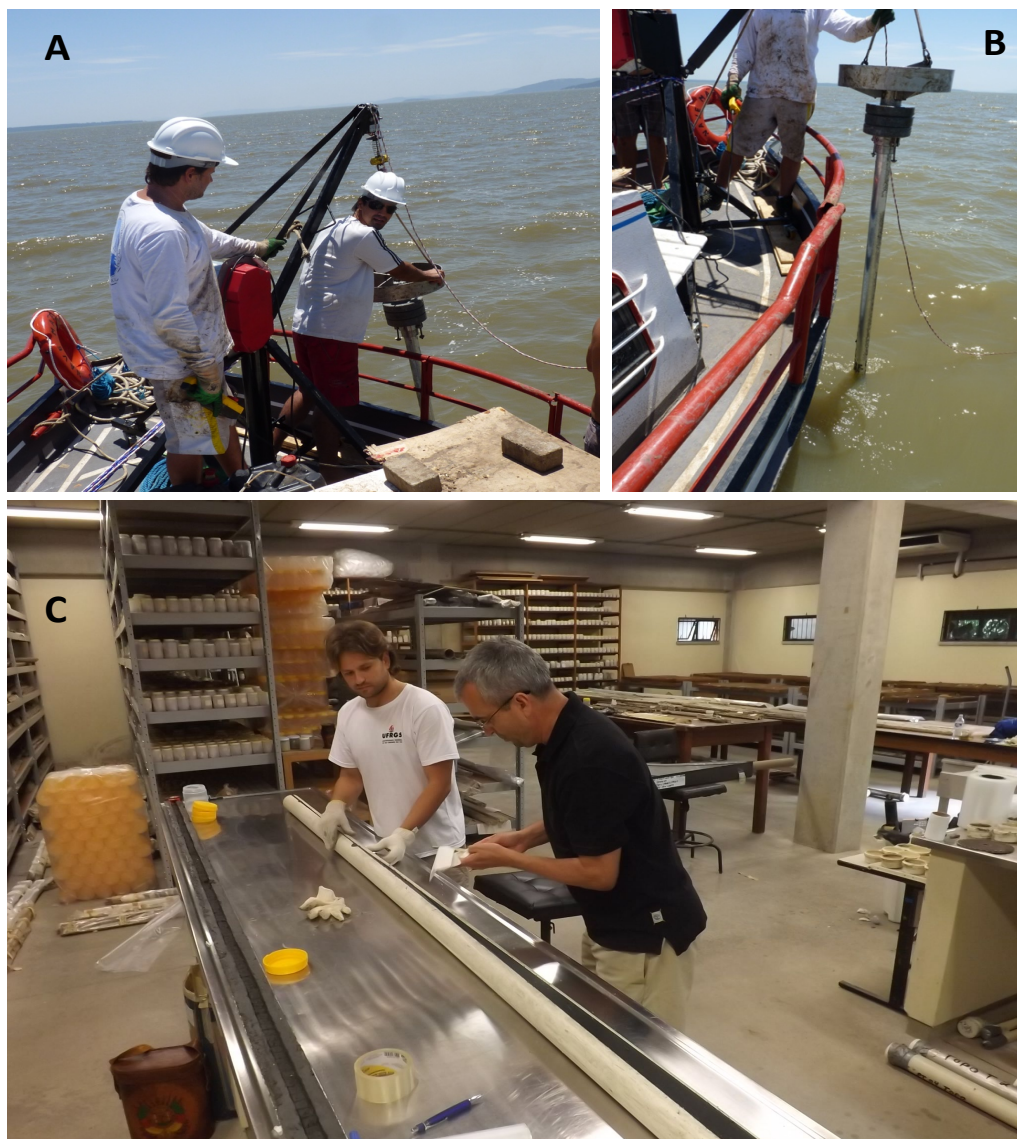
Figura 20 - A) Liberação do testemunhados à gravidade. B) Recuperação do amostrador com guindaste. C) Abertura dos perfis e seleção das amostras para análises na Litoteca do Centro de Estudos de Geologia Costeira e Oceânica (CECO-UFRGS).
