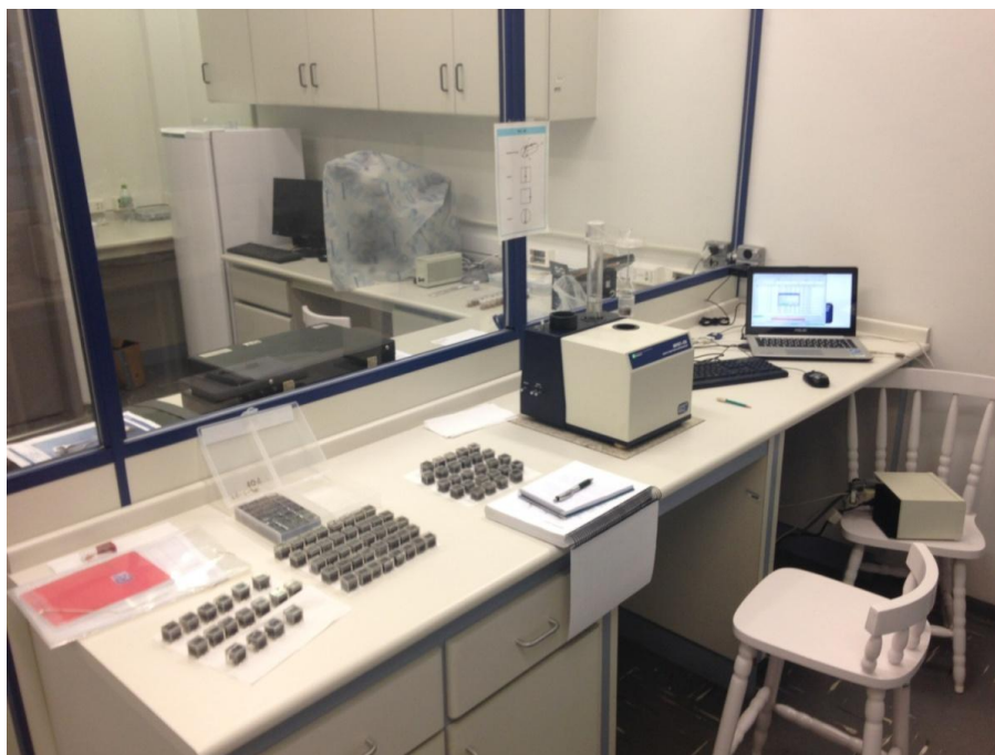
Figura 21 - Susceptômetro MFK1-A Kappabridge (AGICO), utilizado para as medidas de susceptibilidade magnética.
