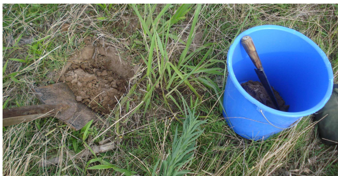
Figura 3 - Imagem ilustrativa da amostragem de solo, com os utensílios utilizados: pá-de-corte, faca e balde para homogeneizar as subamostras.
