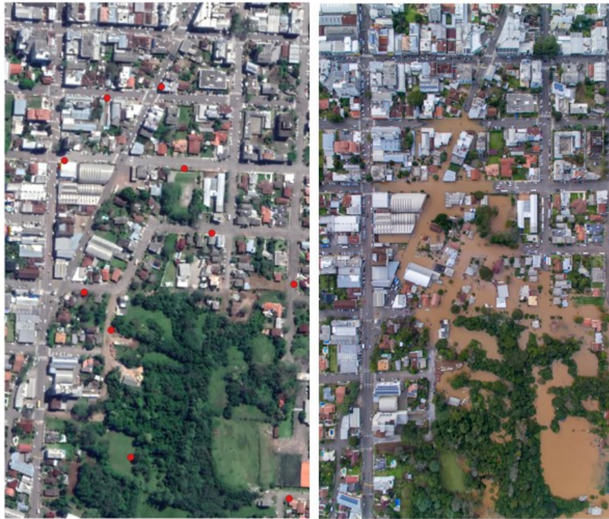
Figura 10. Exemplo da demarcação de pontos, destacados em vermelho, para representação da extensão da mancha de inundação (à esquerda) com base em imagens e/ou vídeos (à direita).
