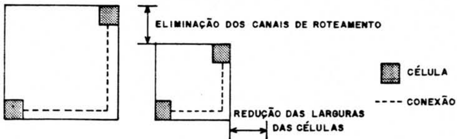
Figura 3.6 - Redução de área e de comprimento de conexões.
