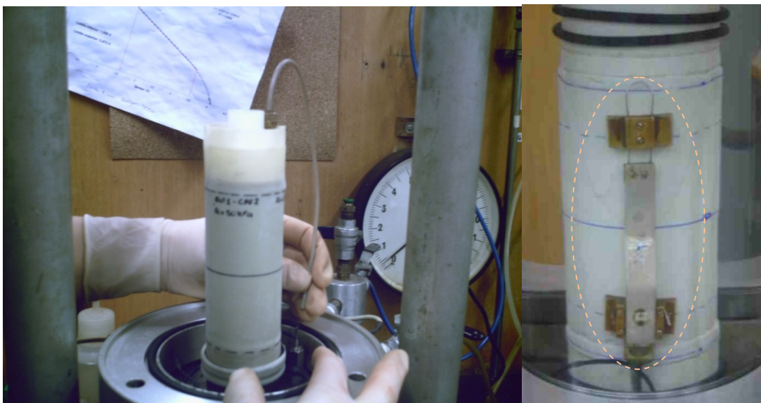
Figura 3.15: Sistema interno de medição de deformações axiais
