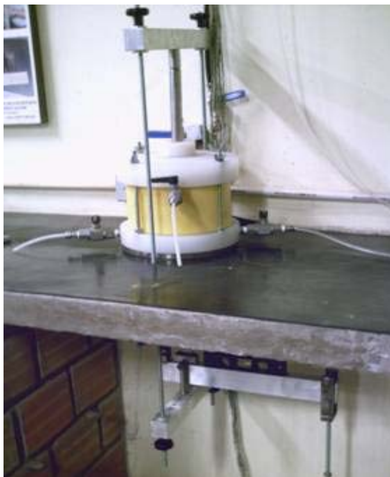
Figura 3.10: Foto da vista geral do oedômetro de lamas
