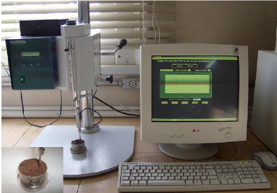
**Figura 5:** Penetrômetro eletrônico de bancada para a determinação da resistência mecânica do solo à penetração.
