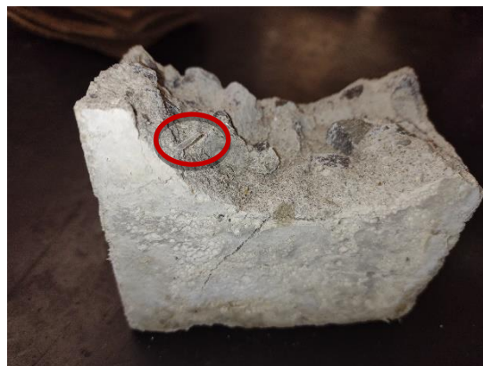
Figura 6: Corpo de prova rompido.
