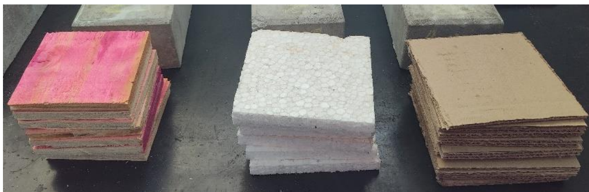
Figura 3: Capeamentos do tipo não colado - madeirite, isopor e papelão (da esquerda para a direita).
