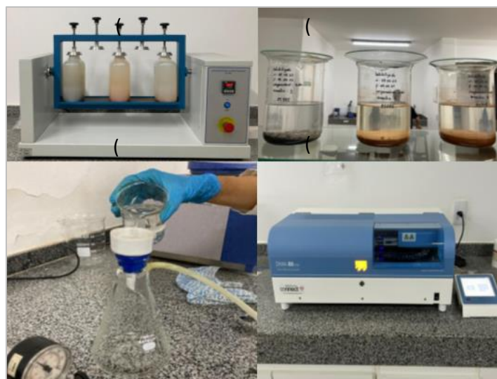
Figura 2 – Ensaio de lixiviação (a), ensaio de solubilização (b), filtração (c) e ensaio de determinação de mercúrio (d).
