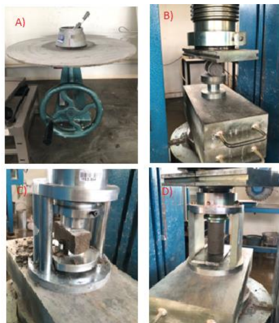
Figura 2: A) Ensaio de índice consistência; B) Ensaio de tração por compressão diametral; C) Ensaio de resistência à compressão axial em corpos-de-prova cúbicos; D) ensaio de resistência à compressão axial em corpos-de-prova cilíndricos
