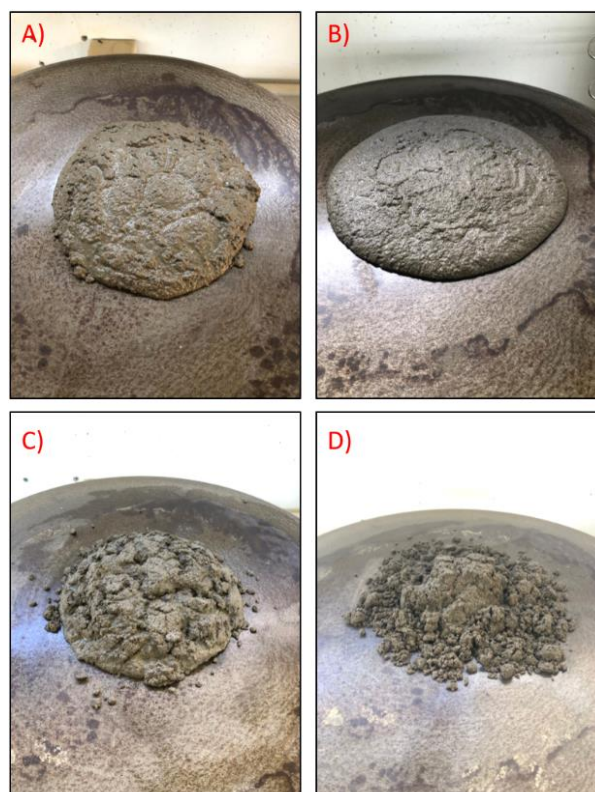
Figura 4: ensaio de consistência: A) AR; B) A1; C) A1,5; D) A2.
