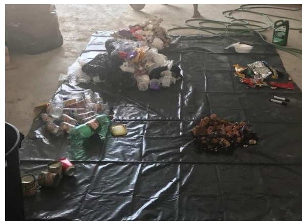
Figura 04: Resíduos segregados após o quarteamento. Fonte: os autores (2018).
