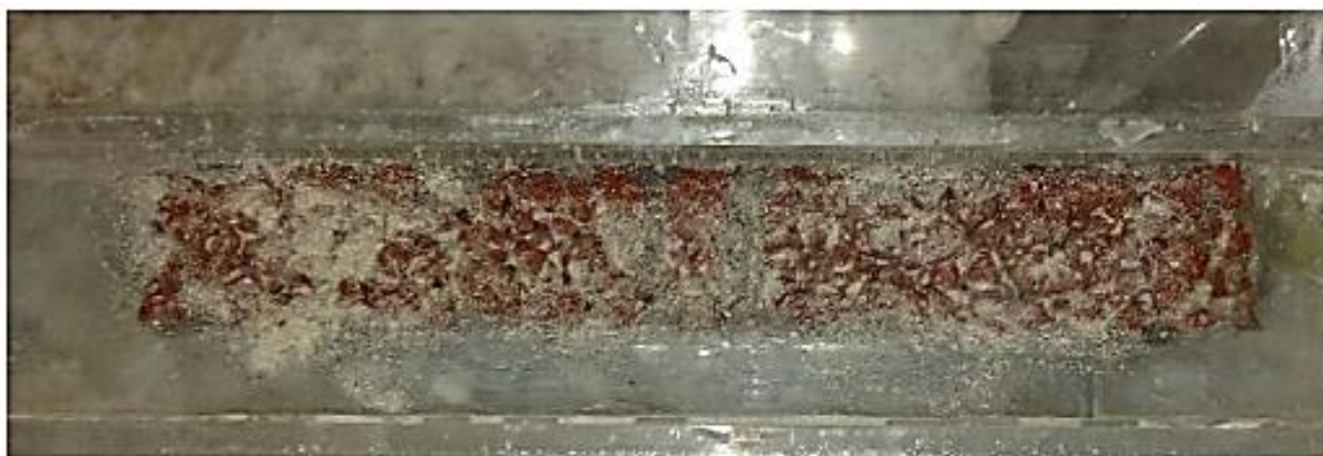
Figura 2 – Detalhe do preenchimento do pavimento poroso com areia
