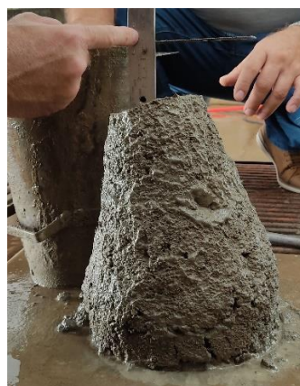
Figura 2: Ensaio de abatimento ( slump test )
