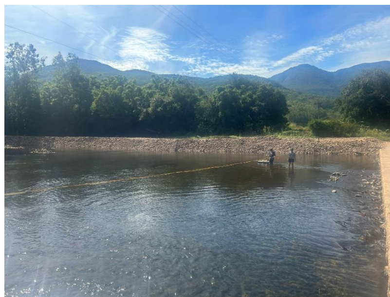
Figura 2: Medição da vazão no rio Maquiné com método ADCP
