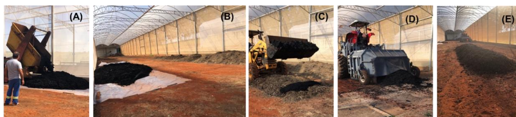
(A) Lodo seco; (B) Material para instalação da leira: lodo desidratado e agente estruturante; (C) Montagem da leira; (D) Revolvidamento. (E) Leira
