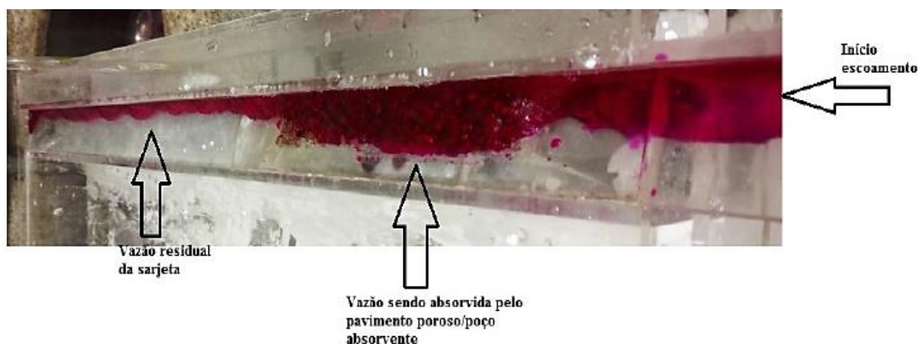
Figura 5 – Visualização do início do escoamento superficial, absorção da tampa/poço de recebimento e escoamento residual a jusante do poço de recebimento.
