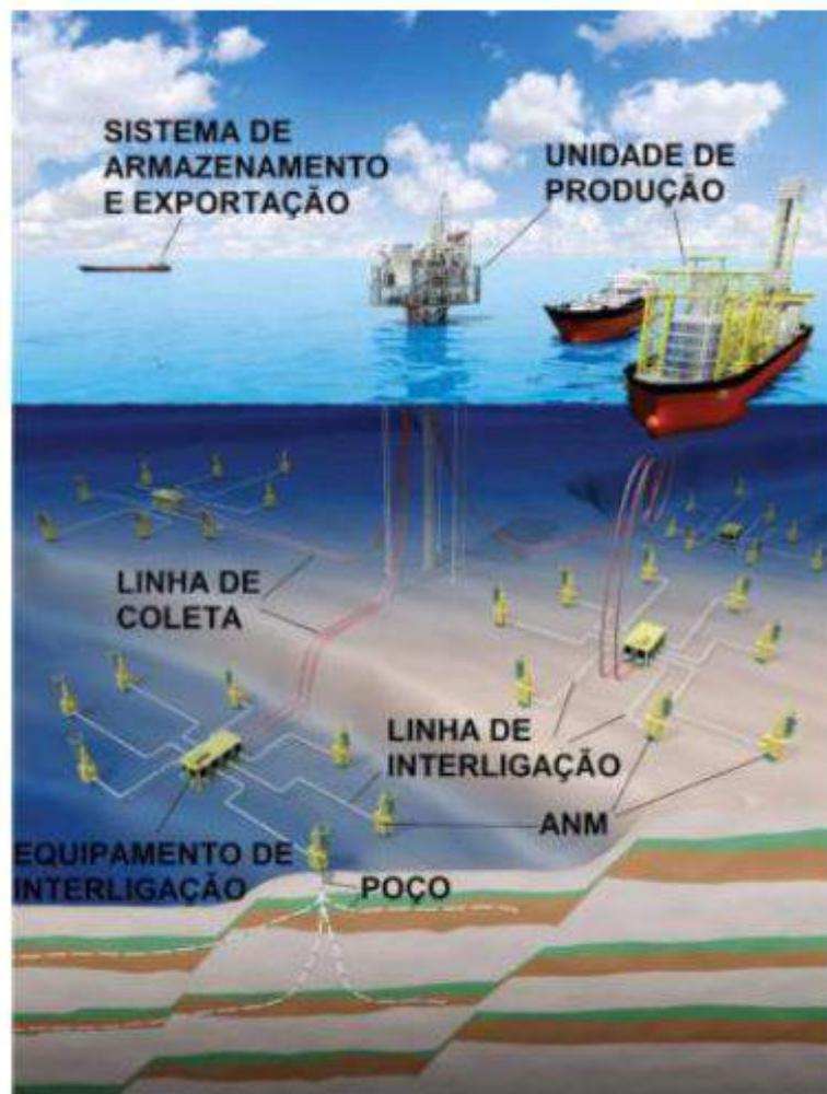
Figura 1.1 – Exemplo da configuração de leito marinho nas imediações de plataformas *offshore*. Fonte: (LAI, 2009).
