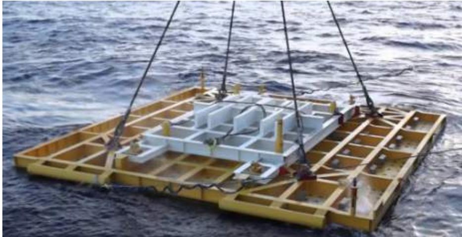
Figura 1.2 – Exemplo de fundação superficial do tipo *mudmat*. Fonte: Safelink (2016).
