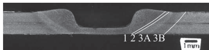
Figura 3. Macroestrutura mostrando localização das diferentes zonas formadas após processamento: 1=zona de mistura (ZM), 2=zona termomecanicamente afetada (ZTMA); 3A, 3B= zona termicamente afetada (ZTA). Condição 1600 rpm – 2s. Ataque Nital 1%.
