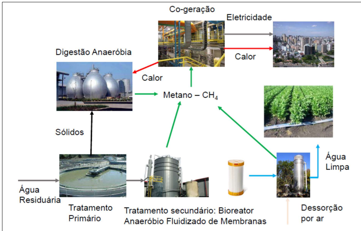
Figura 1: Fluxograma de processos para produção de energia, calor e água de reuso com nutrientes (Fonte: Baseado em McCarty et al. , 2011)
