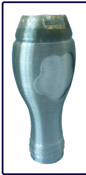
Figura 46. Primeira impressão do reservatório. Fonte: do autor.
