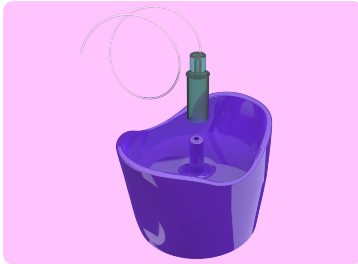
Figura 64. Rendering do detalhe da tampa e seu encaixe na sonda. Fonte: do autor.
