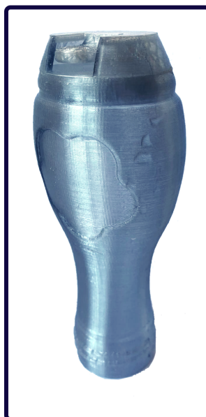
Figura 47. Segunda impressão do reservatório. Fonte: do autor.
