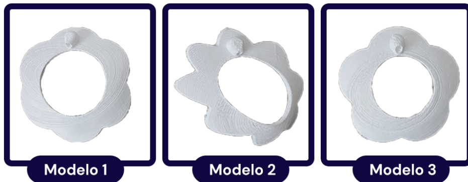
Figura 52. Modelos de elementos de fixação impressos em PLA. Fonte: do autor.
