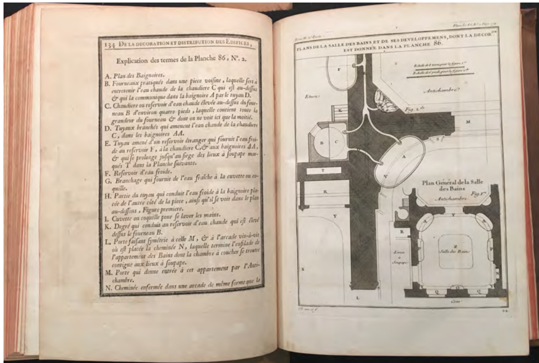
Fig.4.90: No tratado de Jacques-François Blondel, o tratadista ilustrou as caldeiras de água fria e quente e o caminho das tubulações até a banheira no quarto de banho. Fonte: Centro de Pesquisa do MASP, fotografia para uso acadêmico. BLONDEL, Jacques-François. De la distribution des maisons de plaisance, et de la décoration des edifices en general . Paris: chez Charles-Antoine Jombert, libraire du Roy pour l'Artillerie, à l'Image Notre-Dame, M.DCC.XXXVII [1737-1738].
