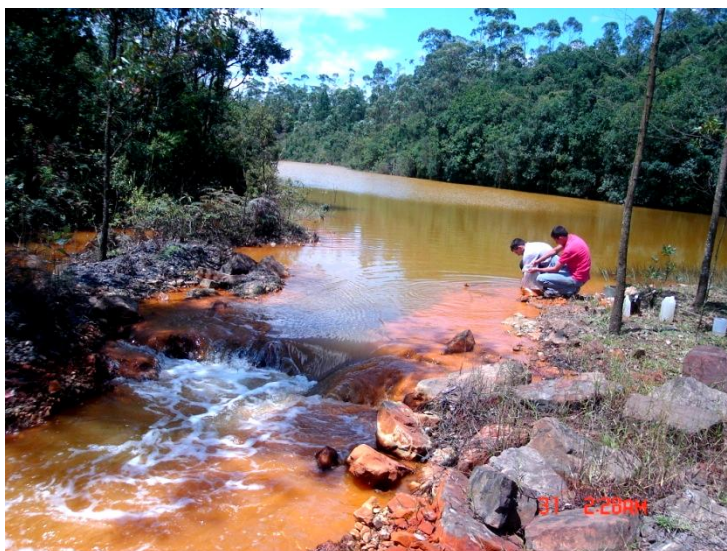
Figura 1. Imagem do encontro de águas de DAM com corpo receptor e deposição de óxidos e hidróxidos metálicos no sedimento e margens da Lagoa Língua do Dragão - Siderópolis/SC [14].
