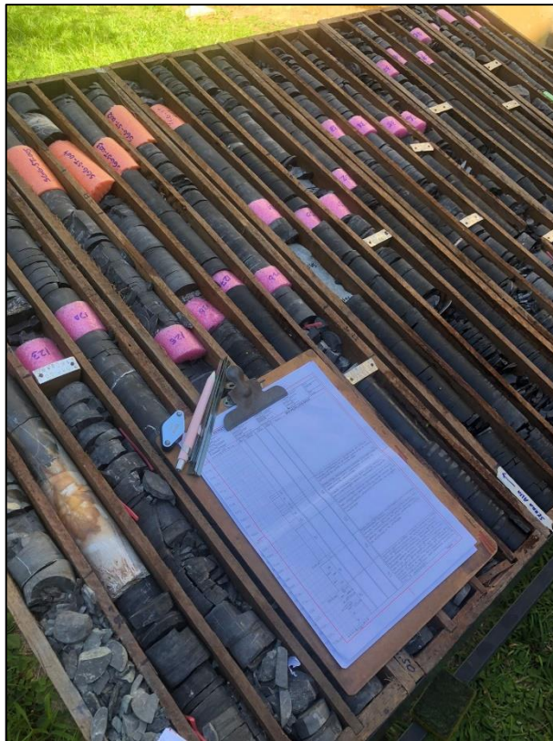
Figura 8. Foto da atividade de descrição litológica do testemunho de sondagem CBM-001-ST-RS.
