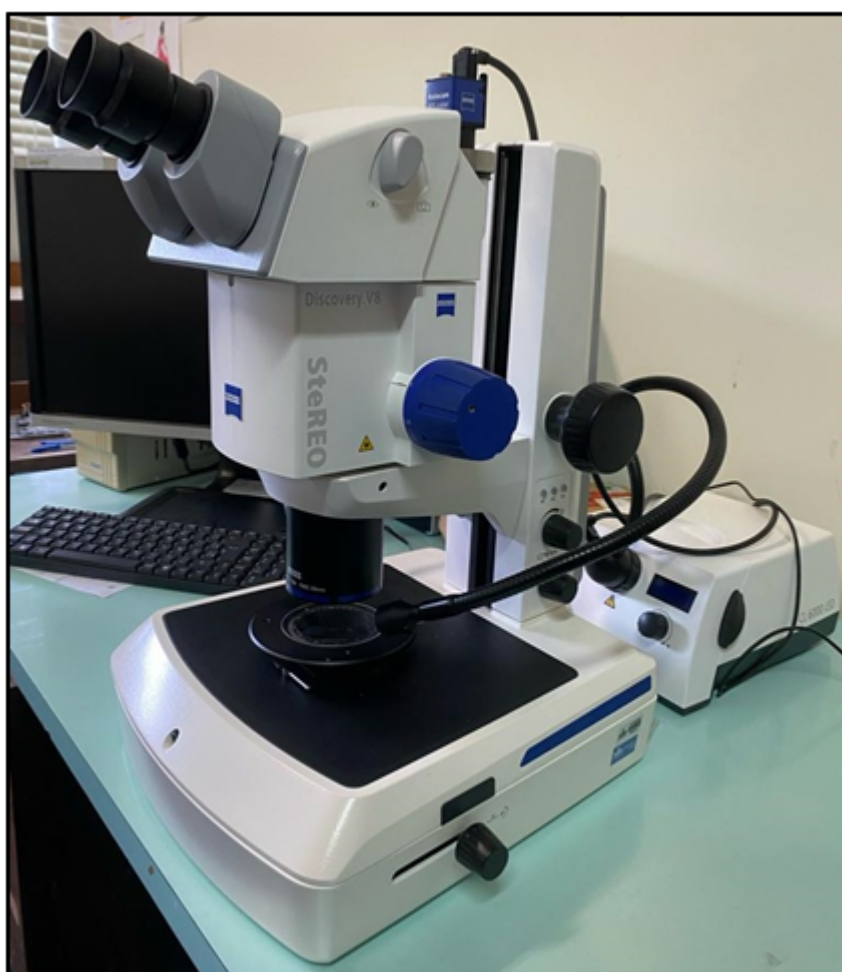
Figura 9. Estereomicroscópio Óptico Zeiss® SteREO Discovery.V8 acoplado a câmera AxioCam 105 color.
