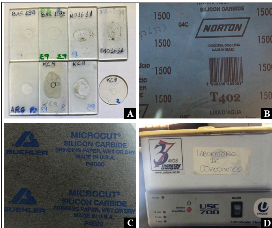
Figura 10. Pastilhas e materiais utilizados para a realização desta etapa do estudo. A) Pastilhas após secagem na estufa. B) Lixa utilizada no aplainamento das pastilhas, Lixa D'Água Microfina N1500 T402 - Norton. C) Lixa utilizada no polimento das pastilhas, Lixa Microcut PSA - P4000. D) Limpador Ultrassônico ( UltraSonic Cleaner ) USC700.
