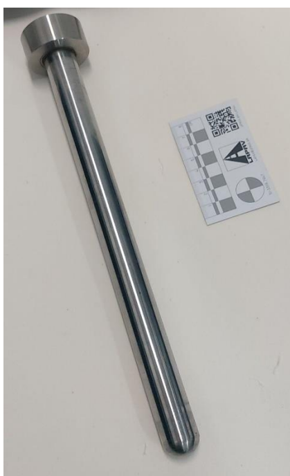
Figura 57: Haste de aplicação de carga
