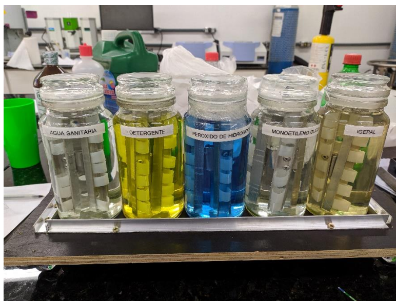
Amostras no banho dos fluidos, antes de serem colocadas na estufa a 50° C. Fonte: Autoria própria.
