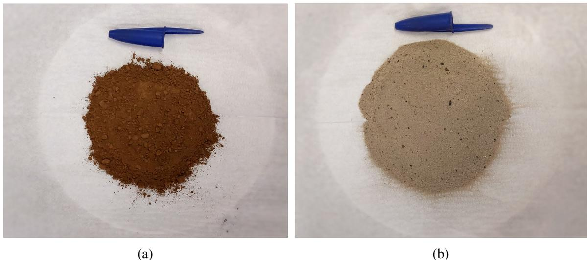
Figura 3.3 – Amostras originais do (a) Rejeito UF e (b) Rejeito F previamente à mistura.
