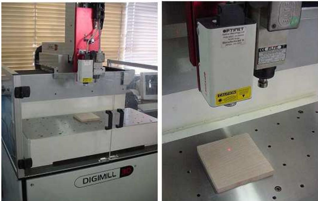
**Figura 25 – Scanner tridimensional a laser modelo Digimill 3D. Equipamento instalado no LdSM/UFRGS**
