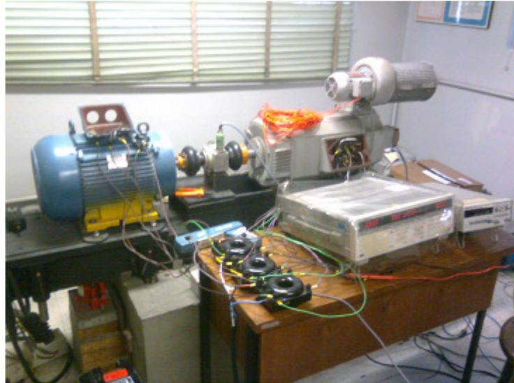
**Figura 20 – Bancada de ensaios do gerador de indução.**
