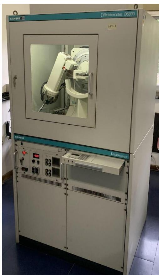
Figura 16: Fotografia do difratômetro utilizado nas análises, localizado no LDRX-UFRGS.
