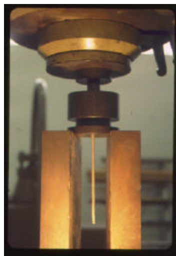
Figura 2 – Processo de extrusão sólida do PVC
