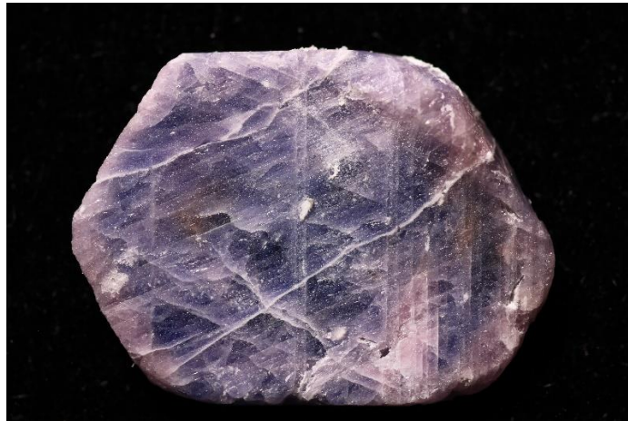
Figura 15. Amostra C09 intensamente fraturada após o tratamento térmico.
