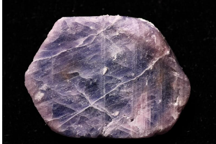
Figura 21. Amostra C09 intensamente fraturada após o tratamento térmico.
